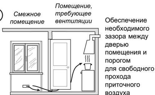
Обеспечение необходимого зазора между дверью помещения и порогом для свободного прохода приточного воздуха
