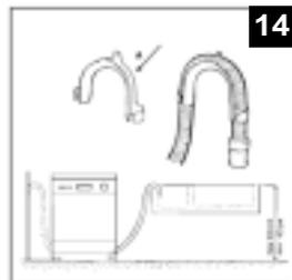
**Специальную пластиковую направляющую следует прочно закрепить на стене, чтобы предотвратить перемещение сливного шланга и разбрызгивание воды.**
