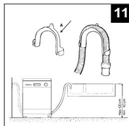
**Специальную пластиковую направляющую следует прочно закрепить на стене, чтобы предотвратить перемещение сливного шланга и разбрызгивание воды.**
