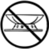
Не включайте горелку без поддерживающей подставки для посуды, это приведет к концентрации и отклонению тепла на поверхность оборудования.
