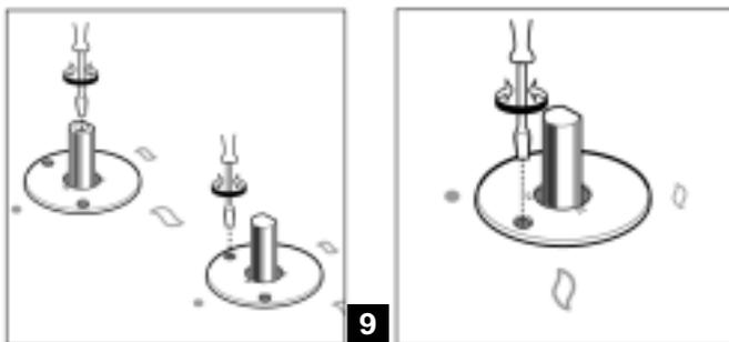
**Н.В.** В случае с сжиженным газом регулировочный винт должен быть закручен по часовой стрелке полностью.
