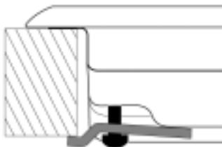
Положение фиксатора при  $H = 30$  мм
